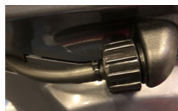
Påmonteret skyllestuds (standset motor)
